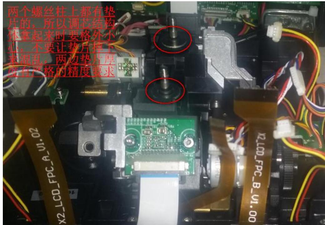
4.拆下来调芯结构如下，按下图步骤松开调芯光耦控制板，转轴固定顶丝，最后取下齿轮。
