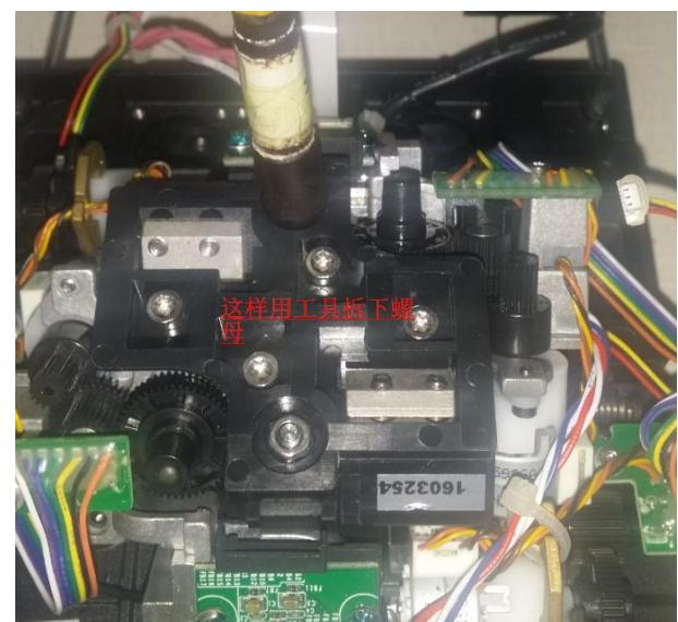
3.拆下调芯模块，注意拿起是要小心点，摇一摇（怕粘在结构上提起的时候掉下来），底下有垫片，垫片不能掉，这个垫片有严格精度要求，不能混，必须保持垫片与原来一致。
