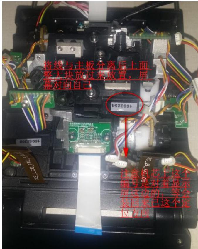
2. 找到工具拆下图中标示的螺母。
