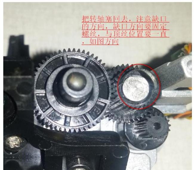
6.将调芯模组装回去，注意图中要求以及之前指出的模组方向(编码贴方向对着显示屏那边)。之所以要求向图中这样用力是因为保证装回去光纤在屏幕的位置与拆之前一致。
