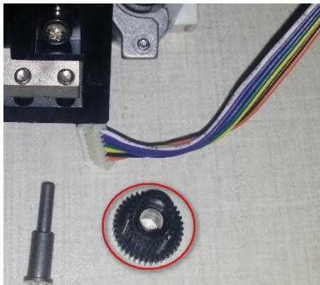
5.把厚点的齿轮更换按图装回去，注意齿轮方向。
